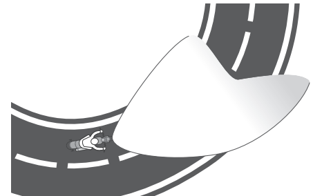
Luz de carretera adaptativa encendida (en curva)
