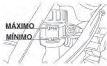
A medida que las pastas de freno se van desgastando, es normal que el nivel del líquido de frenos disminuya gradualmente.
