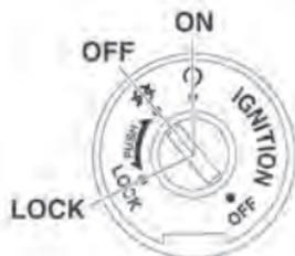
El interruptor principal/seguro de la dirección controla los sistemas de encendido y de luces, y también permite asegurar/bloquear la dirección. Las tres posiciones del interruptor se describen a continuación.
