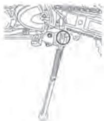
El funcionamiento del soporte lateral se debe revisar siempre antes de conducir la motocicleta, y el pivote y las superficies metálicas de contacto se deben lubricar si es necesario.
