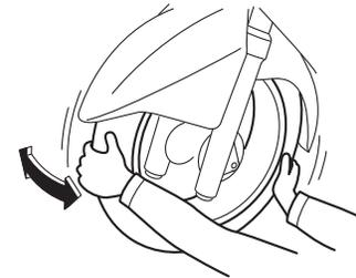
Los rodamientos tanto de la rueda delantera como de la trasera se deben revisar según los intervalos especificados en la tabla de lubricación y mantenimiento general. Si el cubo de la rueda tiene juego libre o si la rueda no gira con suavidad, lleve su motocicleta a un concesionario Yamaha para que revisen los rodamientos de la rueda.
