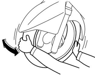
Debe comprobar los cojinetes de las ruedas delantera y trasera según los intervalos que se especifican en el cuadro de mantenimiento periódico y engrase. Si el cubo de la rueda se mueve o si no gira con suavidad, solicite a un concesionario Yamaha que revise los cojinetes de la rueda.
