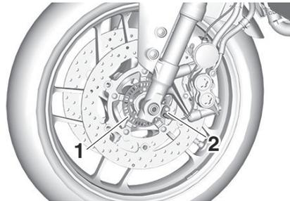
1. Rotor del sensor de la rueda delantera
