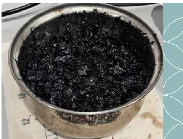
◆ *Prototipo de asfalto hecho a partir de lodos de pintura.*
