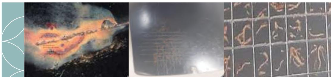
◆ *Imágenes de corrosión filiforme sobre superficies metálicas.*
